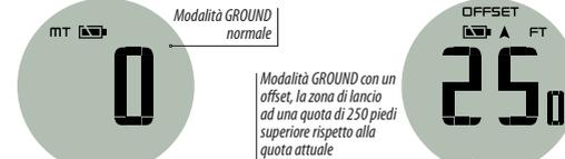
Per risparmiare la batteria, lo strumento utilizza una modalità a basso consumo, durante la quale visualizza l'ora. È possibile visualizzare nuovamente la modalità GROUND facendo click sul pulsante. Al decollo lo strumento passerà automaticamente alla modalità altimetro da entrambe le modalità GROUND e orologio.
