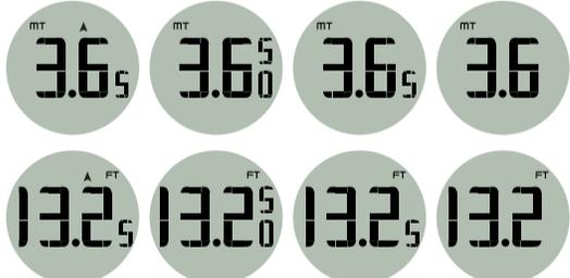
**SIMULATION** - Utile pour s'entraîner à lire l'altimètre, la fonction simule un saut et le vol voile ouverte. Il peut être interrompu en cliquant sur le bouton. Les altitudes de sortie et d'ouverture peuvent être ajusté (voir les fonctions respectives ci-dessous). Entrer en mode simulation, l'écran LCD affichera brièvement l'altitude d'ouverture définie, puis l'altitude de sortie. Appuyez sur le bouton pour lancer la simulation.
