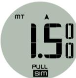
**MODE HORLOGE** - L'Altix intègre une horloge afin que vous puissiez l'utiliser comme une montre! Lorsque vous activez l'appareil (par exemple après un changement de pile), vous pourrez régler l'heure. En mode veille, l'appareil affichera l'horloge.
