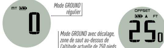
Afin d'économiser la batterie, l'appareil passera en mode horloge si inutilisé pendant un moment. Vous pouvez afficher le mode GROUND en appuyant sur le bouton. Au décollage, l'appareil passera automatiquement en altimètre à partir des modes horloge et GROUND.
